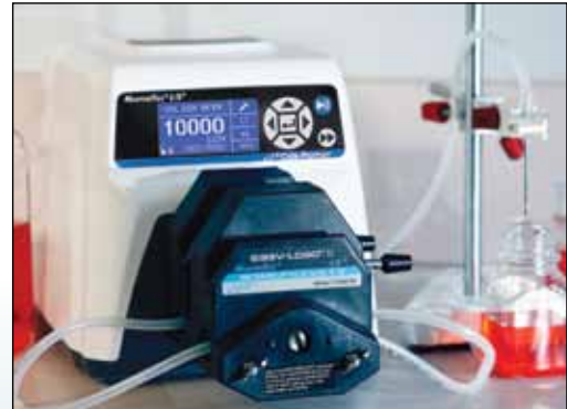
Los controladores digitales L/S de velocidad variable son ideales para aplicaciones de llenado repetitivo y de dispensado. Apile cabezas para reducir la pulsación e incrementar las tasas de flujo.
